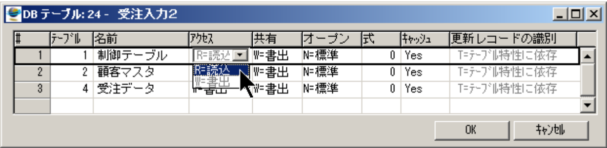
図 17-10 DB テーブルで、制御テーブルのアクセスを「R=読込」にしてロックを回避する。
